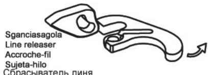
**PT** – O mecanismo foi inserido na parte superior do punho. O liberador, que pode ser posicionado no lado direito e no lado esquerdo, é do tipo lateral com movimento excêntrico separado do sistema de desengate. Cada uma das partes internas foi estudada com relação à geometria e ao material, para garantir o melhor funcionamento e duração:
